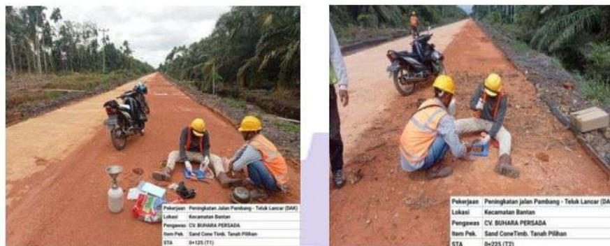
**Gambar 3. 28 Pekerjaan Pengujian Sand Cone**
