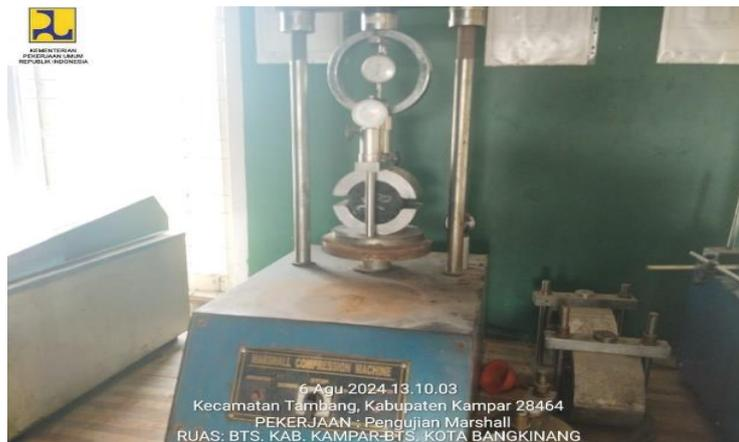
**Gambar 3.21 Pengujian Marshal**
