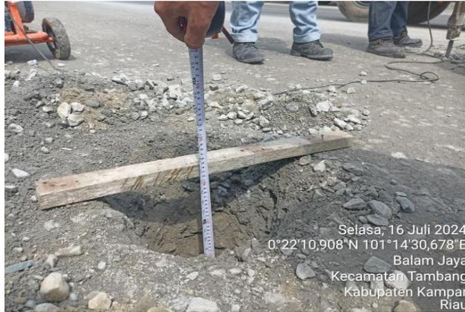
**Gambar 4.5 Pengukuran Tebal Base**
