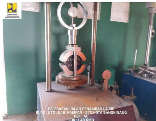
**Gambar 4. 15 Uji Marshall menggunakan mesin marshal**
