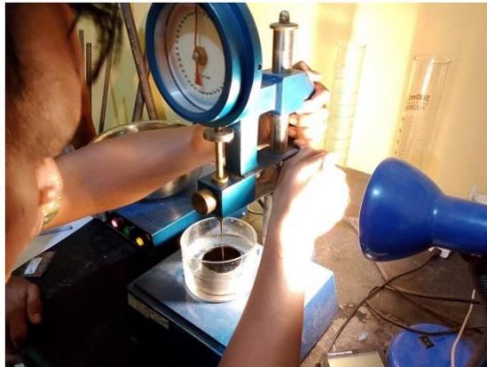
**Gambar 4. 25 Uji Penetrasi**
