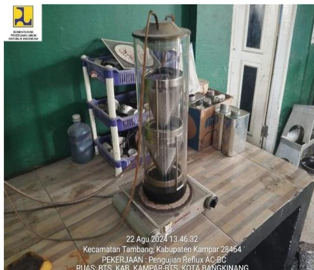
**Gambar 3.20 Pengujian Ekstraksi**
