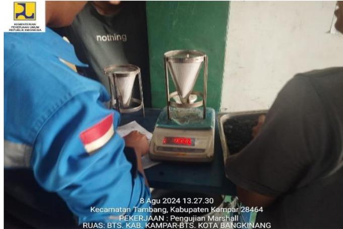
**Gambar 4. 18 Timbangan Berat Agregat Kering**
