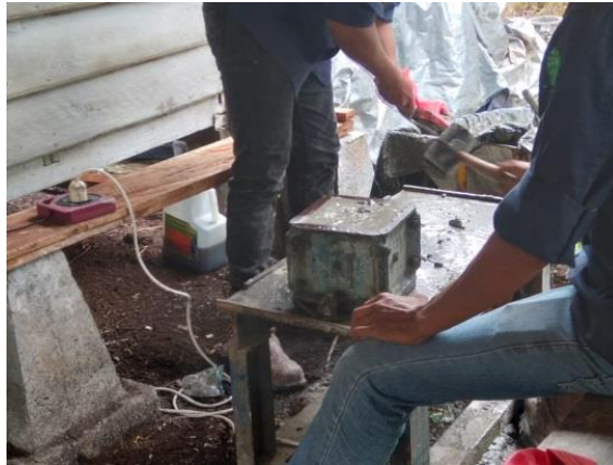
Gambar 3. 18 Pembuatan Beton Kubus Lc Sumber : Dokumentasi lapangan 2024
