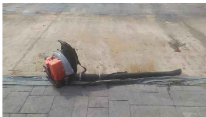
Gambar 4. 2 Pekerjaan Pembersihan Kotoran Menggunakan *Compressor*
