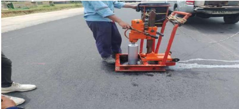
Gambar 4.10. Pengujian *Core Drill*
