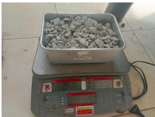
Gambar 3. 30 Menimbang sampel (Sumber : Dokumentasi Tugas Akhir, 2025)
