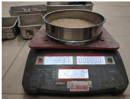
Gambar 3. 34 Menimbang setiap saringan + sampel (Sumber : Dokumentasi Tugas Akhir, 2025)
