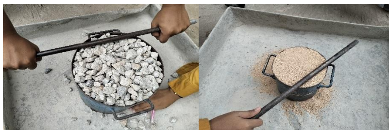
Gambar 3. 52 Ratakan permukaan agregat dengan mistar (Sumber : Dokumentasi Tugas Akhir, 2025)
