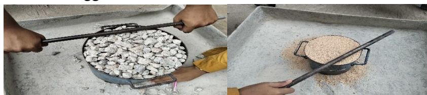
Gambar 3. 56 Ratakan permukaan agregat dengan mistar (Sumber : Dokumentasi Tugas Akhir, 2025)
