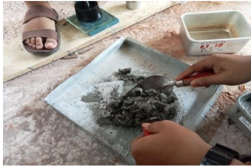
Gambar 3. 66 Pengadukan secara merata (Sumber : Dokumentasi Tugas Akhir, 2025)
