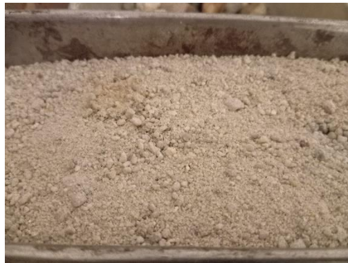
Gambar 3. 22 Agregat Halus (Sumber : Dokumentasi Tugas Akhir, 2025)
