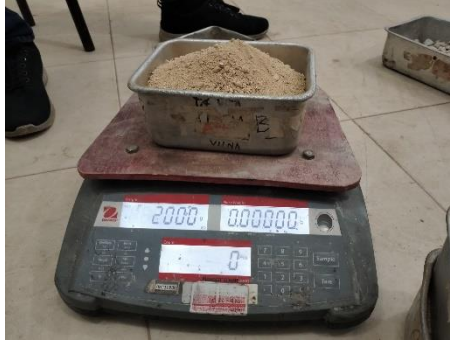
Gambar 3. 36 Menimbang sampel yang telah dioven seberat 1000 gram (Sumber : Dokumentasi Tugas Akhir, 2025)
