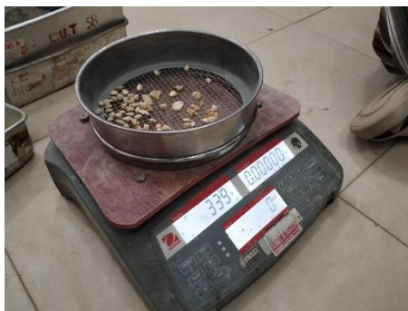
Gambar 3. 32 Menimbang setiap saringan + sampel (Sumber : Dokumentasi Tugas Akhir, 2025)
