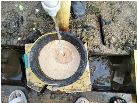
Gambar 3. 37 Mencuci agregat yang sudah lolos saringan No.200 (Sumber : Dokumentasi Tugas Akhir, 2025)
