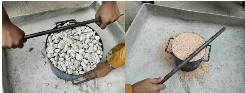
Gambar 3. 48 Ratakan permukaan agregat dengan mistas (Sumber : Dokumentasi Tugas Akhir, 2025)
