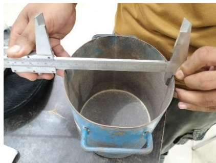
Gambar 3. 49 Mengukur diameter mould (Sumber : Dokumentasi Tugas Akhir, 2025)
