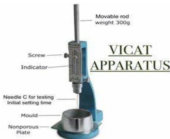
Gambar.2. 3 Vicat Apparatus (Sumber : Google, 2025)
