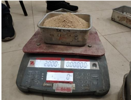
Gambar 3. 36 Menimbang sampel yang telah dioven seberat 1000 gram (Sumber : Dokumentasi Tugas Akhir, 2025)
