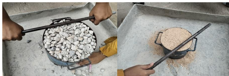
Gambar 3. 52 Ratakan permukaan agregat dengan mistas (Sumber : Dokumentasi Tugas Akhir, 2025)
