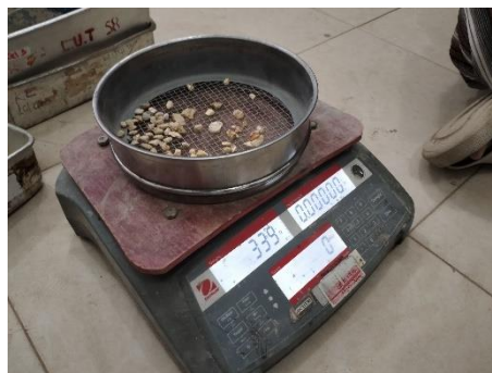
Gambar 3. 32 Menimbang setiap saringan + sampel (Sumber : Dokumentasi Tugas Akhir, 2025)
