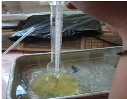
Gambar 3. 60 Menyamakan suhu cairan dalam botol (Sumber : Dokumentasi Tugas Akhir, 2025)
