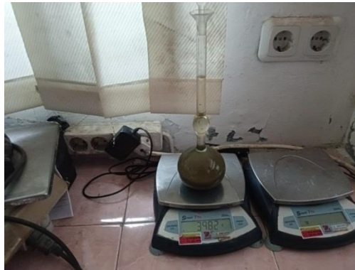
Gambar 3. 61 Timbang Botol Le Chatelier dan Isi (Sumber : Dokumentasi Tugas Akhir, 2025)
