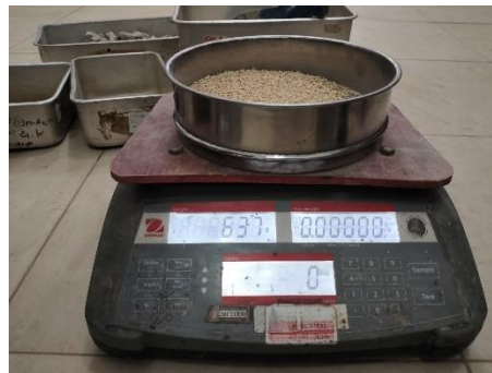
Gambar 3. 34 Menimbang setiap saringan + sampel (Sumber : Dokumentasi Tugas Akhir, 2025)
