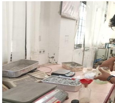
Gambar 3. 43 Masukkan sampel kedalam botol gelas (Sumber : Dokumentasi Tugas Akhir, 2025)
