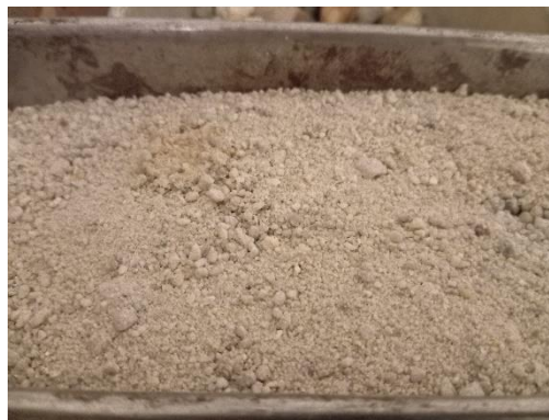
Gambar 3. 22 Agregat Halus (Sumber : Dokumentasi Tugas Akhir, 2025)
