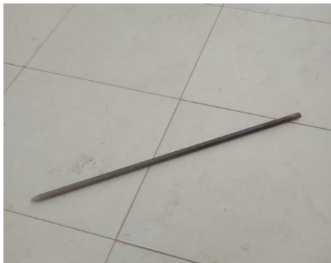
Gambar 3. 15 Perojok Besi (Sumber : Dokumentasi Tugas Akhir, 2025)
