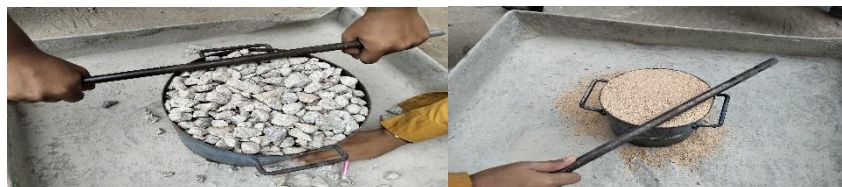
Gambar 3. 56 Ratakan permukaan agregat dengan mistas (Sumber : Dokumentasi Tugas Akhir, 2025)
