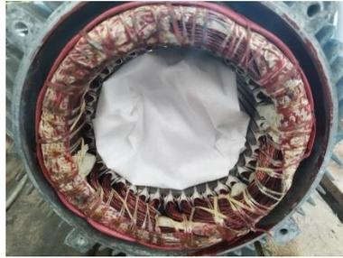
Gambar 4.10 Pembersihan Stator dan Rotor
