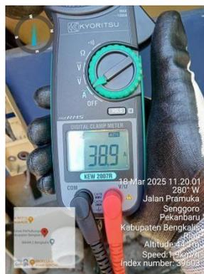
Gambar 4. 3 Pengukuran beban trafo siang.
