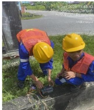
Gambar 3. 4 Pengukuran pentanahan body trafo,system dan netral
