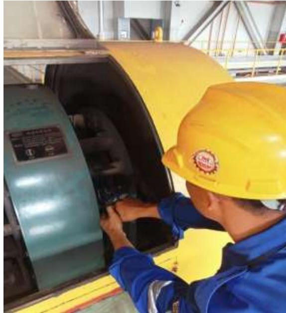
Gambar 4. 22 proses pemasangan holder
