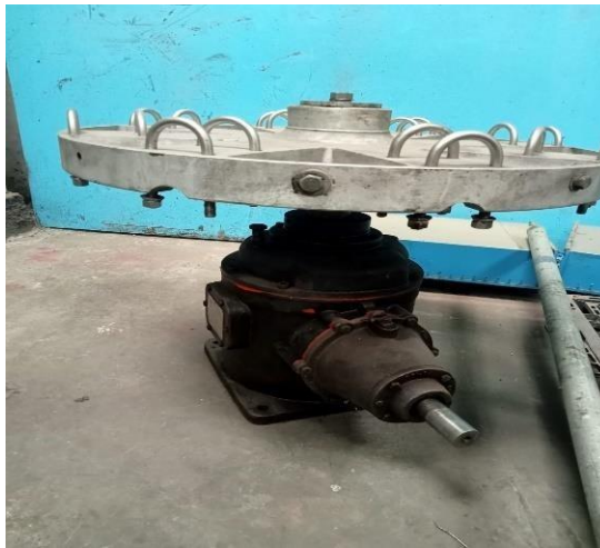
Gambar 4. 1 Gearbox Amarillo F110 Sumber: Dokumentasi, 2025
