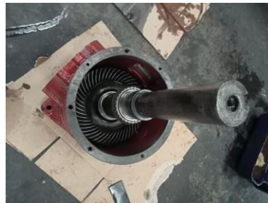
Gambar 4. 12 Pembukaan Penutup Atas Sumber: Dokumentasi,2025
