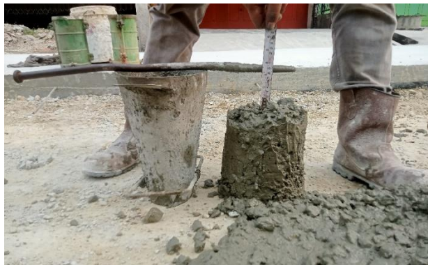
Gambar 3. 31 Pegujian Slump (Sumber: Dokumentasi KP, 2024)
