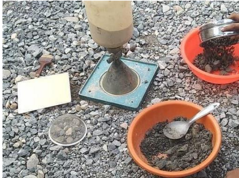
Gambar 3. 15 Alat uji Sand Cone sumber :Dokumentasi lapangan,2024
