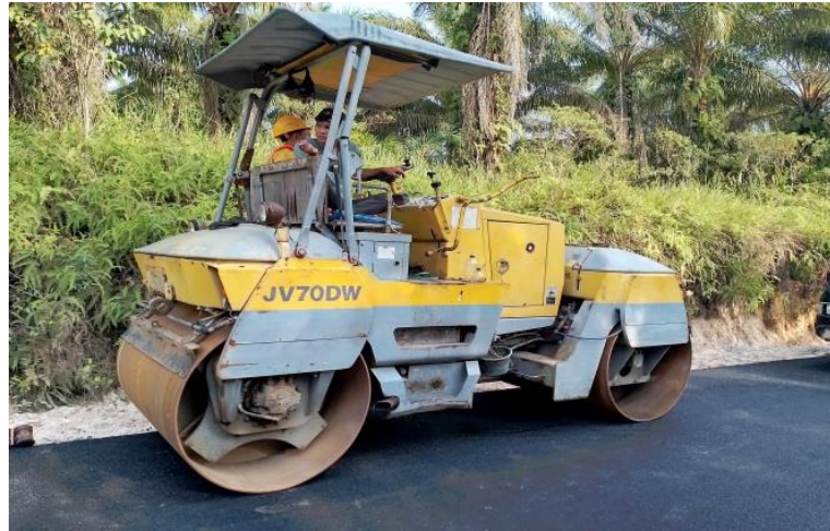
Gambar 3. 7 Tandem Roller Sumber : dokumentasi lapangan, 2024
