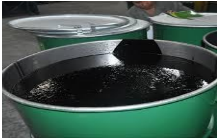
Gambar 3. 20 Prime Coat sumber : dokumentasi lapangan, 2024
