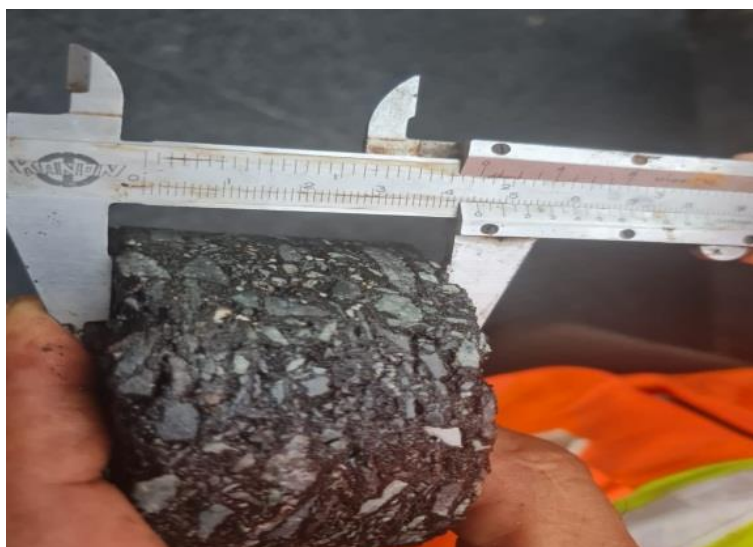
Gamabr 4. 10 pengujian Core Drill Sumber : dokumentasi lapangan,2024
