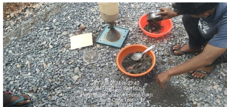
Gambar 3. 31 Pengujian Sand Cone Sumber : dokumentasi lapangan, 2024
