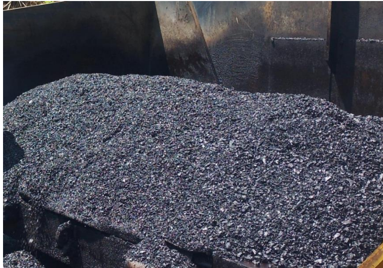
Gambar 3. 23 Aspal AC – WC Sumber : dokumentasi lapangan, 2024
