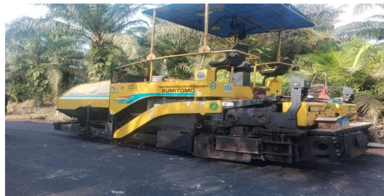
Gambar 3. 6 Asphalt Finisher sumber : dokumentasi lapangan, 2024
