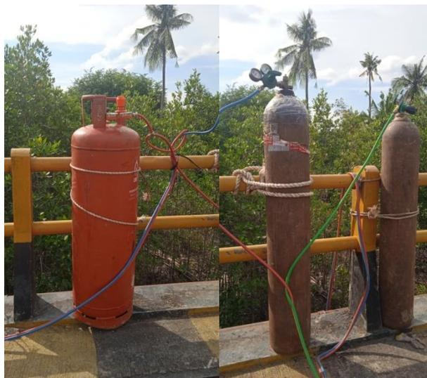
Gambar 4. 37 gas 50 kg dan oksigen 60kg yang digunakan untuk cutting torch memotong pipa baja
