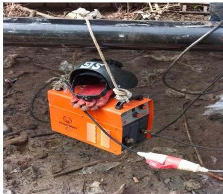
*Gambar 4. 23 Alat las yang digunakan untuk menyambung pipa bracing*
