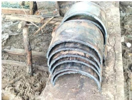
*Gambar 4. 35 Potongan pipa untuk klem bracing*
