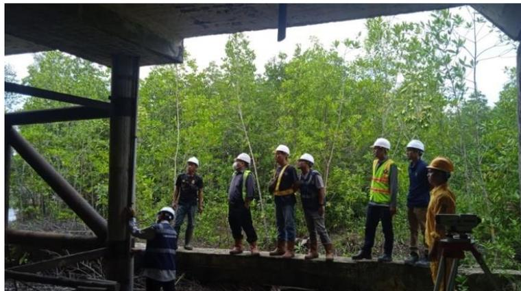
*Gambar 4. 1 Survei elevasi tinggi bracing menggunakan waterpas dan bak ukur*
