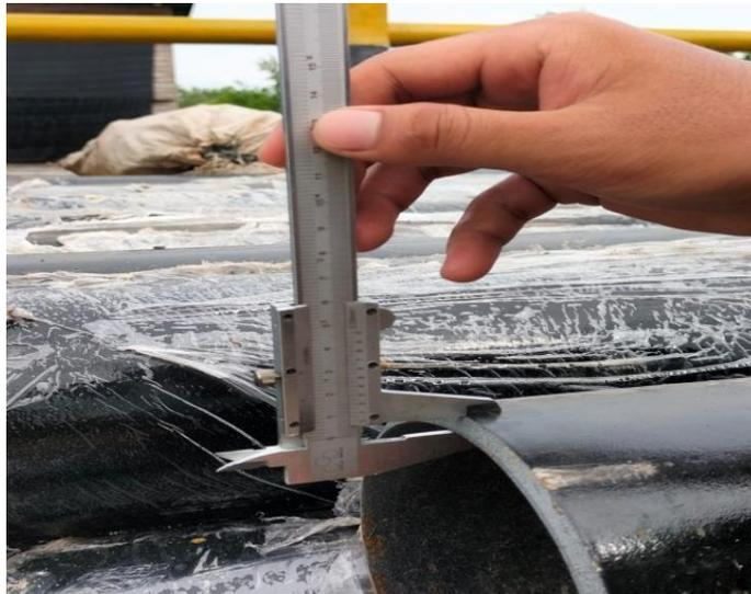
*gambar 3. 2 survei pengecekan material bracing*
