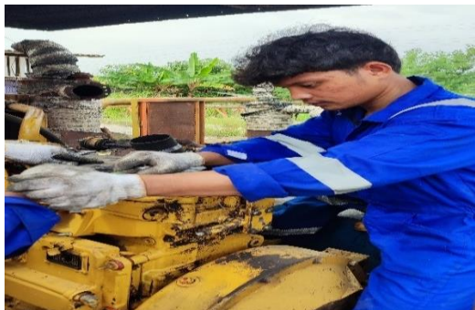
Gambar 3.21 Pembongkaran cover head cylinder ARJ-07 (Sumber : Dokumentasi Pribadi)
