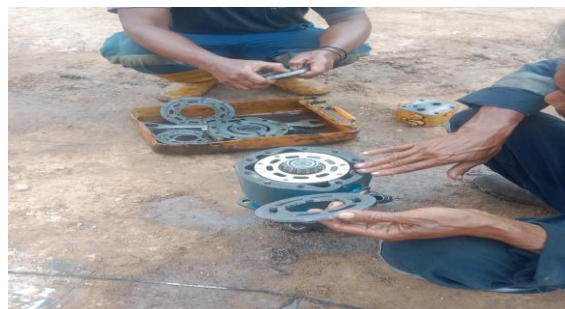
Gambar 3.31 Overhaul dan cleaning motor hidrolik type 4633 Bowen swivel 3.5 power asembly ARJ-09 (Sumber : Dokumentasi Pribadi)
