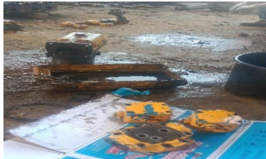
Gambar 3.3 Pembongkaran motor hidrolik type 4633 ARJ-06 (Sumber : Dokumentasi Pribadi)
