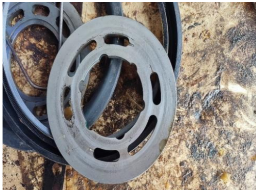
Gambar 4.11 Kondisi sebelum Replacement Bearing Plate (Sumber: Dokumentasi Pribadi)
