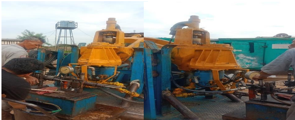
Gambar 4.15 Pressure test motor hidrolik type 4633 menggunakan hand pump pressure test . (Sumber: Dokumentasi Pribadi)
