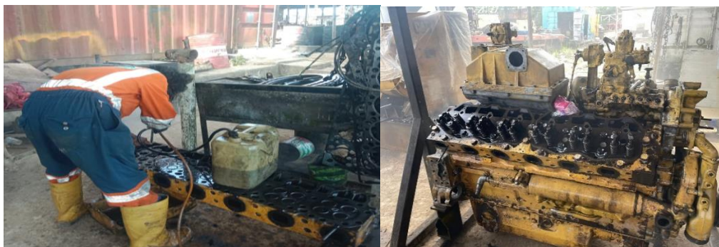
Gambar 3.38 Pemasangan Head Cylinder dan komponen mesin RIG type CAT 3512B ARJ-12
