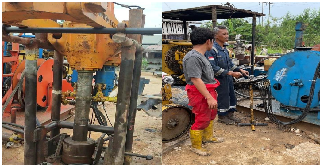
Gambar 4.16 Maximal pressure test motor hidrolik type 4633. (Sumber: Dokumentasi Pribadi)
