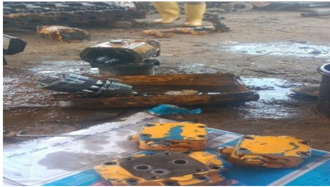
Gambar 4.9 Cleaning komponen motor hidrolik type 4633 ARJ-09 (Sumber: Dokumentasi Pribadi)
