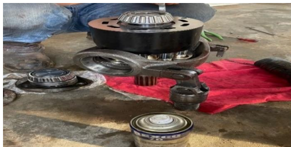
Gambar 3. 19 Perakitan ulang hydraulic pump Bowen S-120 ARJ-06 (Sumber : Dokumentasi Pribadi)
