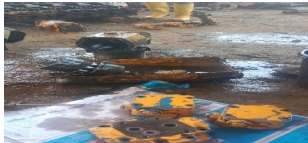
Gambar 3.14 Pergantian Gasket pada motor hidrolik type 4633 (Sumber: Dokumentasi Pribadi)
