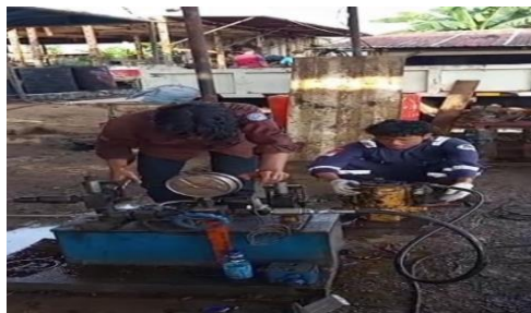
Gambar 4. 7 Pressure Test Motor Hidrolik Type 4633 (Sumber: Dokumentasi Pribadi)
