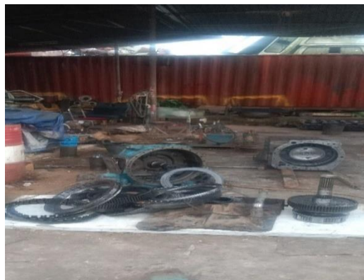
Gambar 3.7 Overhaul transmisi RIG ARJ-05 (Sumber: Dokumentasi Pribadi)
