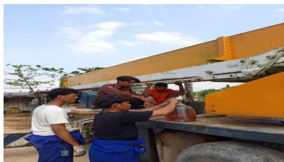
Gambar 3.17 Penambahan oli hydraulic pada crane mobile
