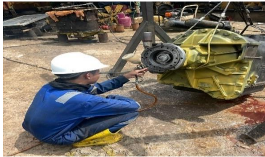
Gambar 3.23 Repaint ulang transmisi ARJ-05 (Sumber : Dokumentasi Pribadi)
