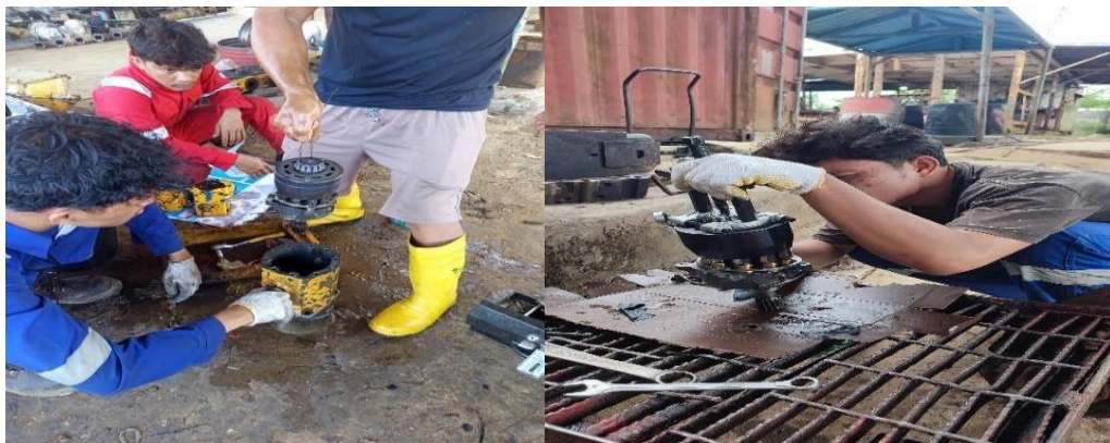
Gambar 4.10 Pengecekan kondisi Rotor Motor hidrolik type 4633 (Sumber: Dokumentasi Pribadi)
