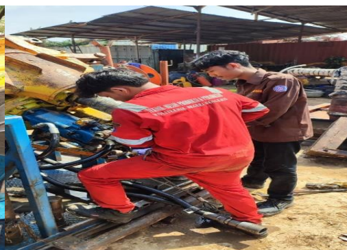
Gambar 4.14 Pemasangan Hydraulic Rotary Union Supply . (Sumber: Dokumentasi Pribadi)
