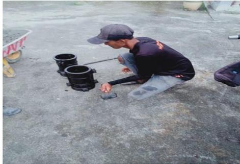
Gambar 3.17: Pembuatan beton silinder untuk rigid
