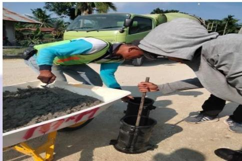
Gambar 3.13: Pembuatan beton silinder untuk lc
