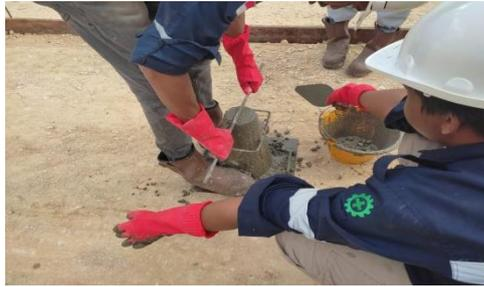
Gambar 3.12: Uji slump untuk lc
