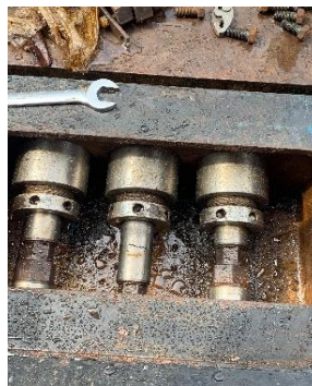
Gambar 4. 4 Kondisi batang piston setelah diperiksa. Sumber : Dokumentasi Lapangan
