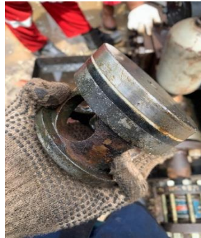
Gambar 4. 3 Kondisi penutup liner dan shell setelah dibongkar. Sumber: Dokumentasi Lapangan
