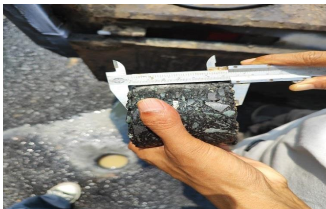
Gambar 4. 10 Hasil Pengujian Core Drill AC-BC Sumber : Dokumentasi lapangan 2024
