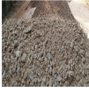
Gambar 3. 18 Material Agregat B Sumber : Dokumentasi lapangan 2024
