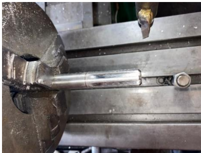
Gambar 4 . 11 Hasil Produksi Poros Spline
