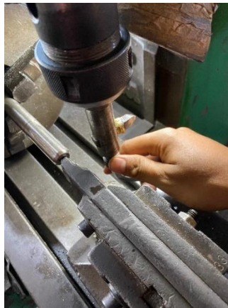
Gambar 4 . 6 Peroses Penyenteran Sumber: Dokumentasi
