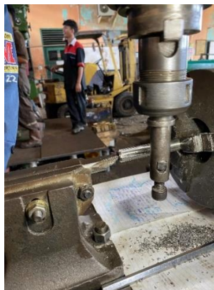
Gambar 4 . 9 Pengulangan Peroses Pemakanan Sumber: Dokumentasi
