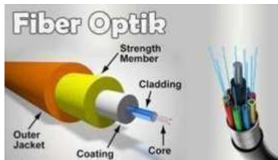
Gambar 3.1 Struktur Kabel Fiber Optik
