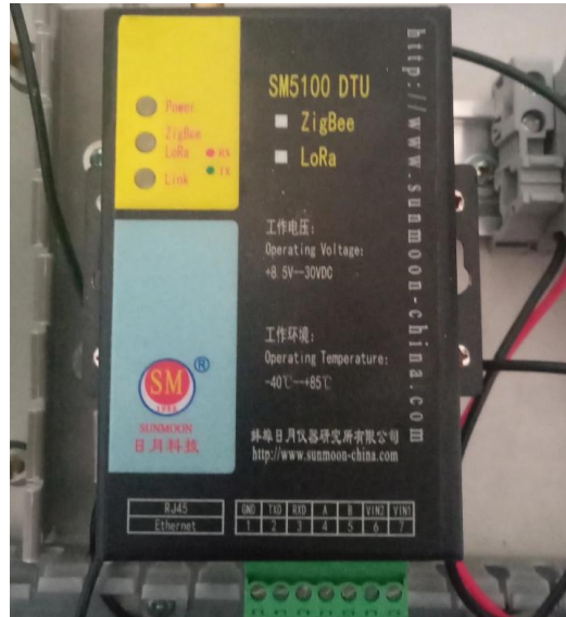
Gambar 3.7 SM5100 DTU didukung ZigBee dan LoRa
