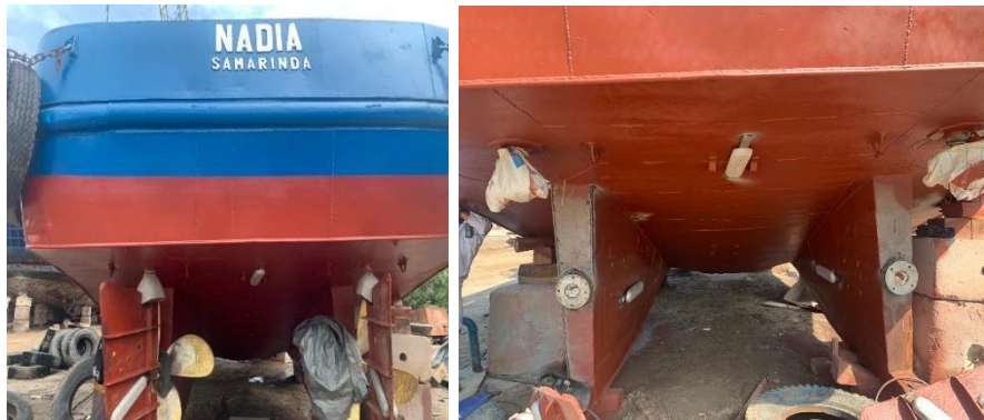
Gambar 3.2. Hasil Pengecatan Anti Korosi Antifouling Paint lapisan terakhir
