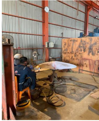
Gambar2.3 Pengecoran tembaga pada daun propeler
