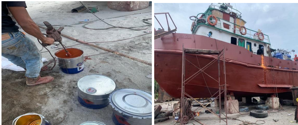
Gambar 3.0. Hasil Pengecatan Anti Korosi Primer
