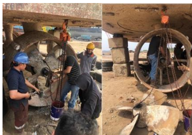
Gambar 2.6 Pelepasan Propeler Kapal Tug Boat
