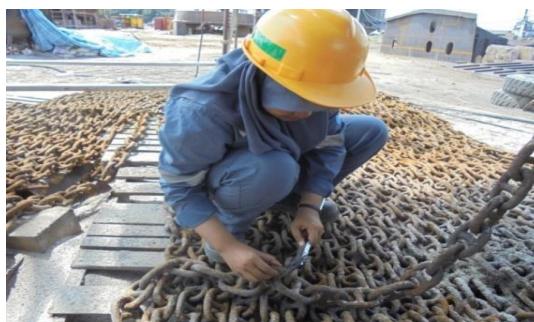
Gambar 2.19 Kalibrasi pada rantai jangkar
