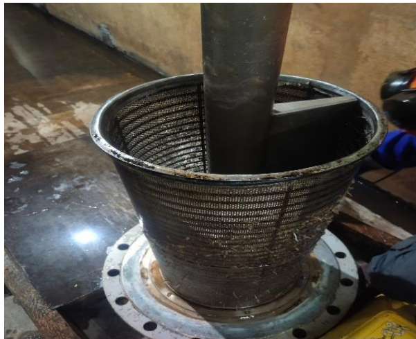
Gambar 3.52 Pencucian pada stainer
