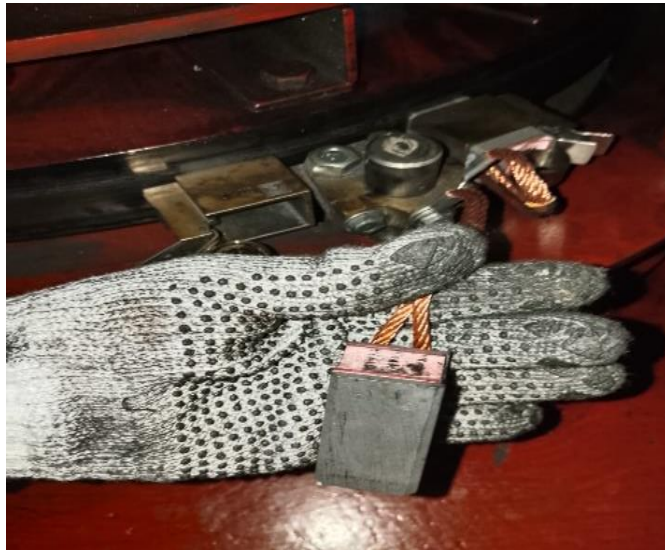
Gambar 3.28 Pembersihan pada carbon brush (Sumber: dokemntasi penulis 2025)
