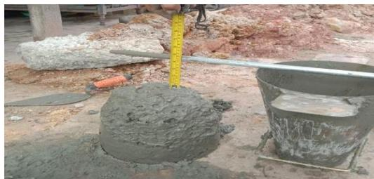
**Gambar 3. 19** Uji Slump
