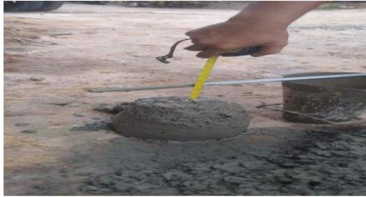
**Gambar 3. 36** Uji Slump
