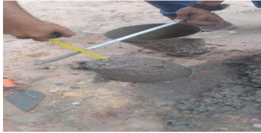
**Gambar 3. 40** Uji Slump
