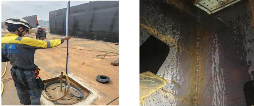
Gambar 3.4 Inspection Air test interal Sumber : Penulis
