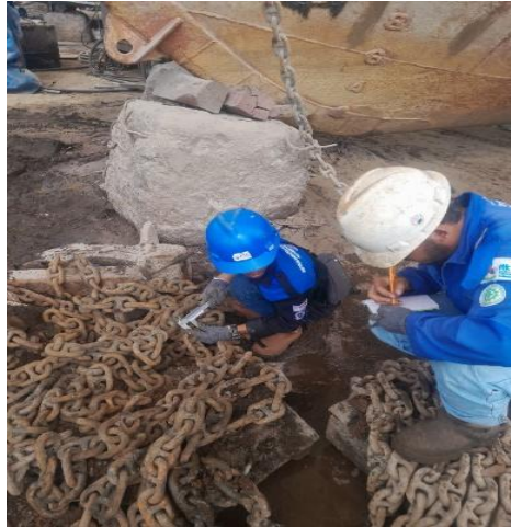
Gambar 3.23 Kalibrasi rantai jangkar TB. HARLINA 3
