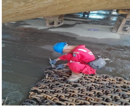
Gambar 3.64 Kalibrasi Rantai Jangkar TB HARLINA 3
