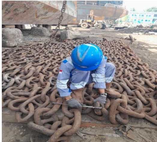
Gambar 3.51 Kalibrasi Rantai Jangkar BG FC.PUSPAWATI
