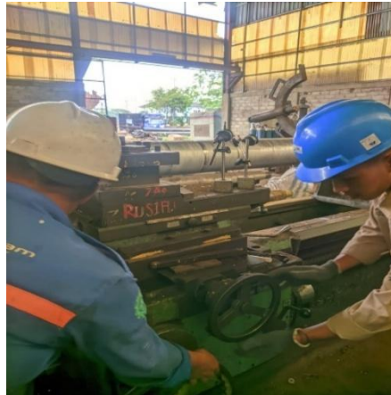
Gambar 3.3 Pelurusan Flange shaft
