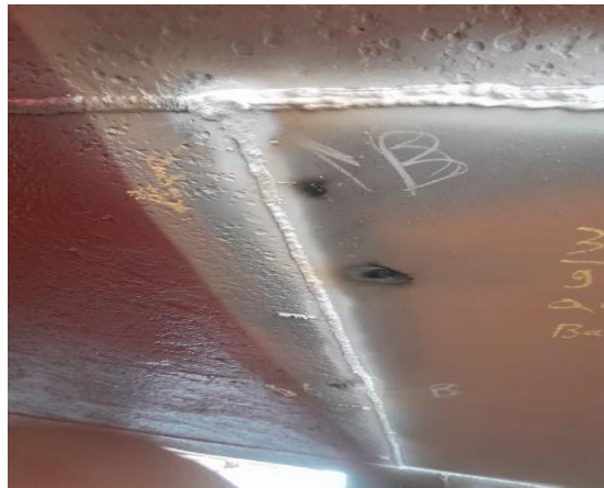
Gambar 3.38 Penetrant Testl TB.HARLINA 3
