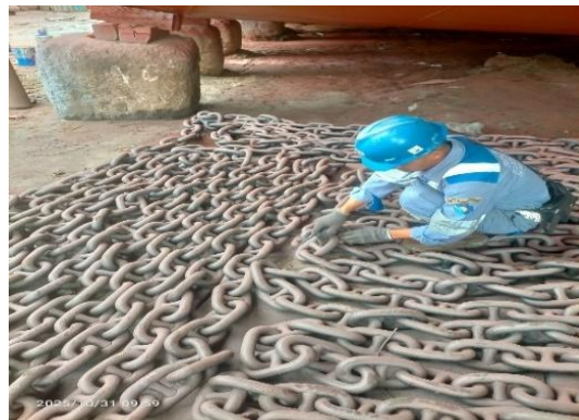
Gambar 3.84 Kalibrasi Rantai Jangkar KMP.JAMBO VIII
