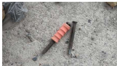
Gambar 3. 20 Pahat beton Sumber : Dokumentasi Lapangan, 2025
