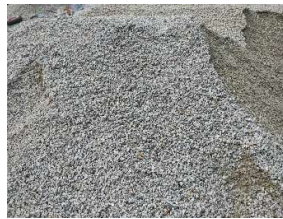
Gambar 3. 14 Batu split 10 mm Sumber : Dokumentasi Lapangan, 2025
