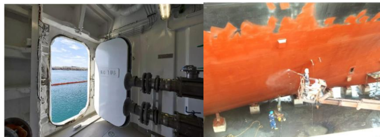
Gambar 3. 31 contoh perbaikan lambung & pintu kedap air kapal
