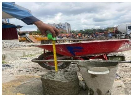
Gambar 3. 12 Pengujian *slump test*
