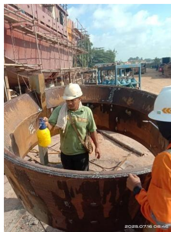
Gambar 2. 16 Air Preasure Test Pada Kort Nozzle
