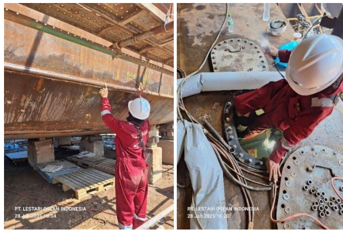
Gambar 3. 25 Air pressure test eksternal dan internal
