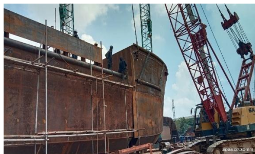
Gambar 3. 30 proses lifting turning up pada head kapal tug boat
