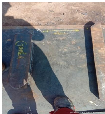
Gambar 3. 24 Web yang salah Cutting dan harus diganti
