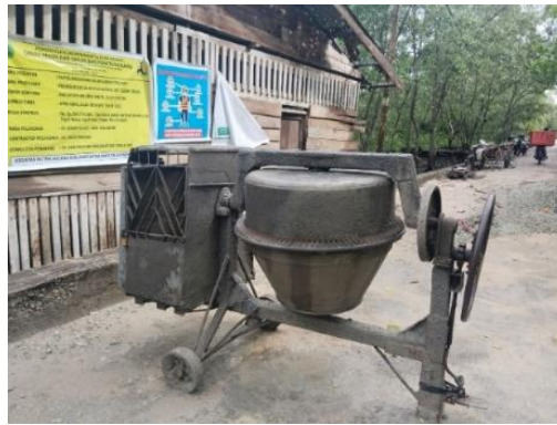
Gambar 3. 38 Concrete mixer Sumber: Dokumentasi Lapangan
