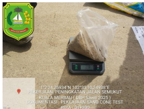
Gambar 3. 17 Menimbang berat tanah basah yang diambil dari lubang Sumber: Dokumentasi Lapangan
