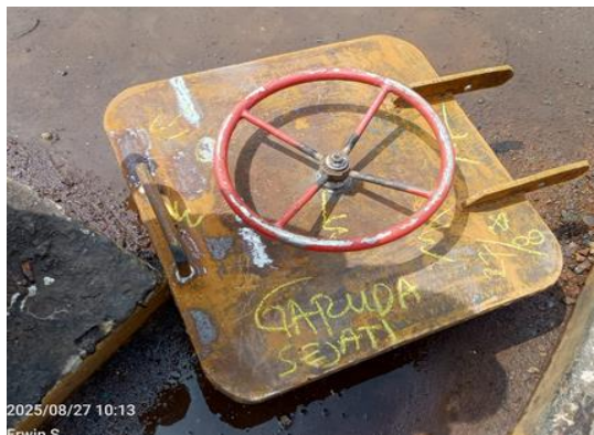
Gambar 3. 58 Visual Weld Pintu Akses Engine Room Garuda Sejati
