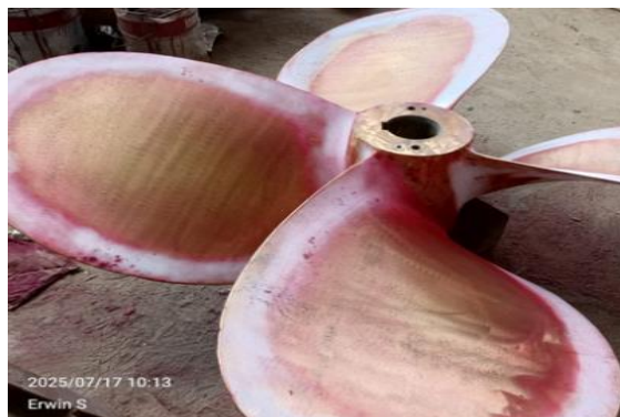
Gambar 3. 4 Penetran Pada Propeler
