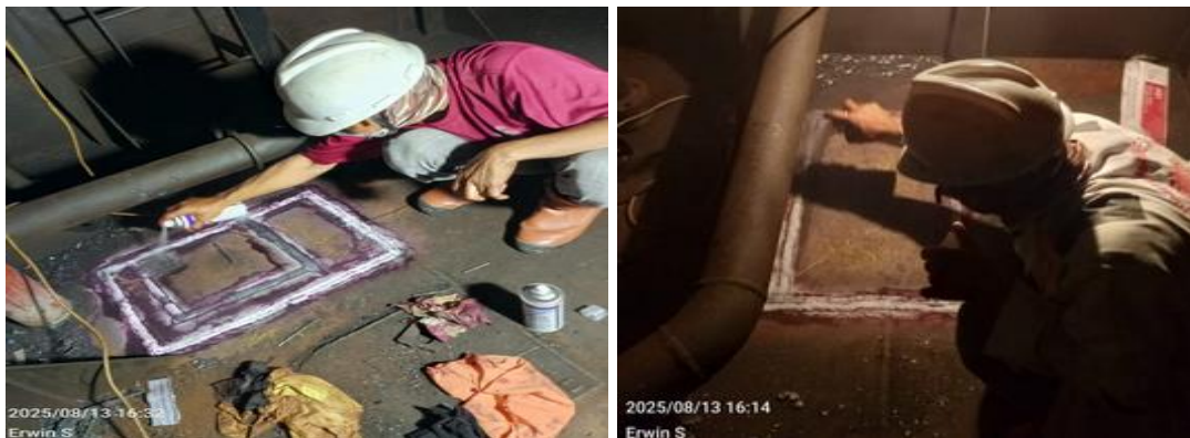
Gambar 3. 42 Penetran Insert Plat Pada Lintas Bahari
