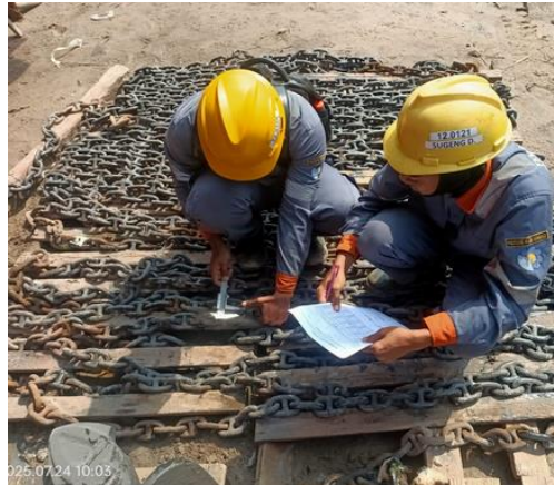
Gambar 3. 20 Pengukuran Jangkar Bima IX
