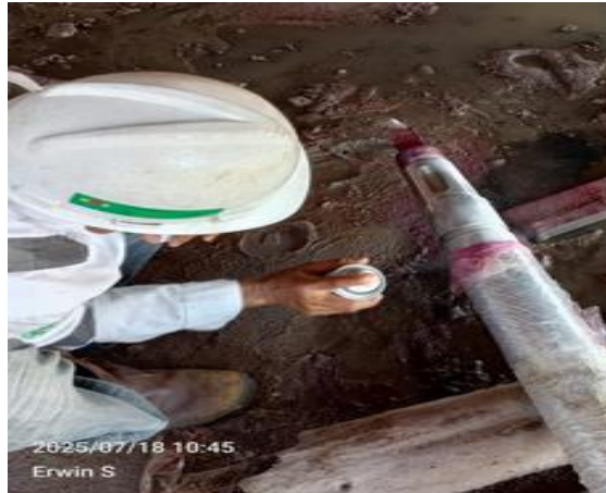
Gambar 3. 11 Penetran Pada Shaft Propeler
