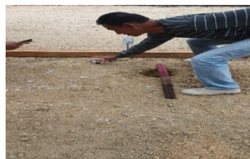
Gambar 3.14 Pengujian Core Drill Base B Sumber : Dokumentasi Lapangan 2025
