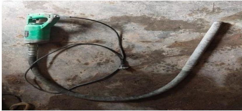
Gambar 3. 86 Concrete vibrator (Sumber : Dokumentasi Lapangan)
