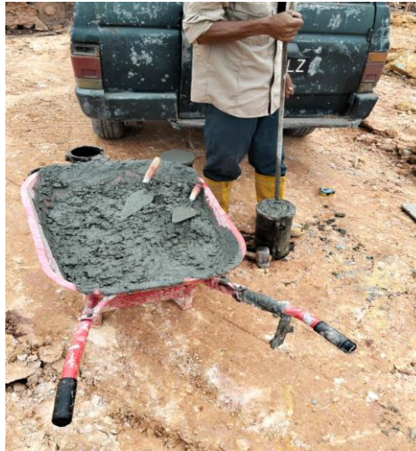
Gambar 1. 15 Beton yang akan diuji tekan (Sumber : Dokumentasi Pribadi, 2025)
