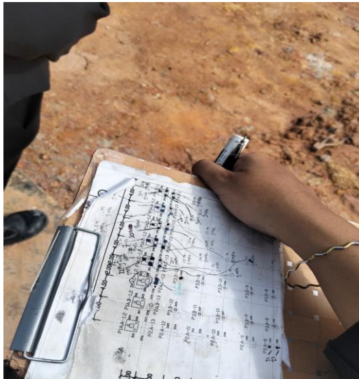
Gambar 1. 20 Mencatat atau Melingkari Tiang yang sudah Terpasang (Sumber : Dokumentasi Pribadi, 2025)
