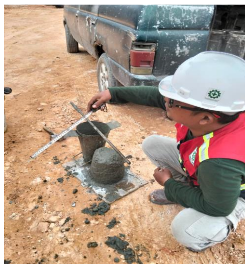
Gambar 1. 12 Pengujian Slump (Sumber : Dokumentasi Pribadi, 2025)
