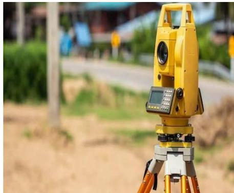
*Gambar 3.10 Penegakan alat statif dan total station
