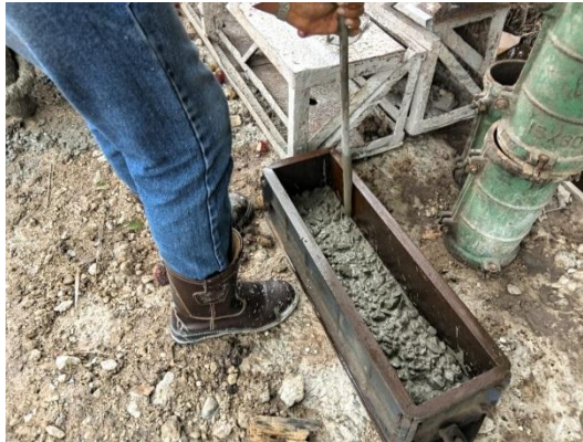
Gambar 3.28: Pembuatan Beton Balok Fs 3,8 Mpa Sumber : Dokumentasi lapangan, 2025
