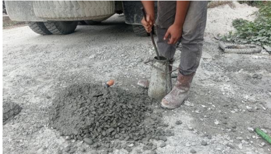
Gambar 3.17: Pekerjaan Uji Slump Untuk Lc Sumber : Dokumentasi lapangan, 2025
