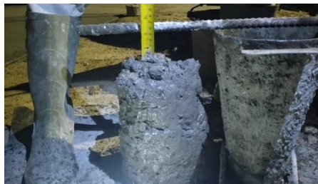
Gambar 3. 18 Uji Slump Rigit Sumber : Dokumentasi KP,2024
