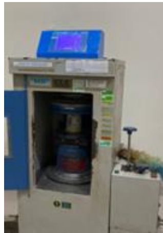
Gambar 3. 72 Pengujian uji kuat tekan
