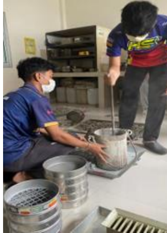
Gambar 3. 39 Proses pemadatan berat isi padat
