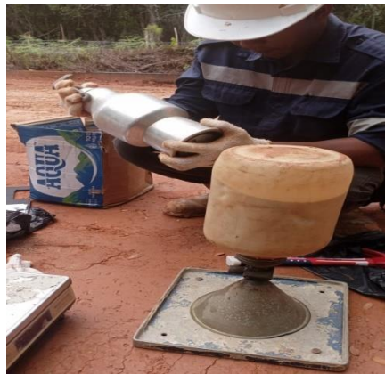
Gambar 3. 11 Pengujian sand cone tanah
