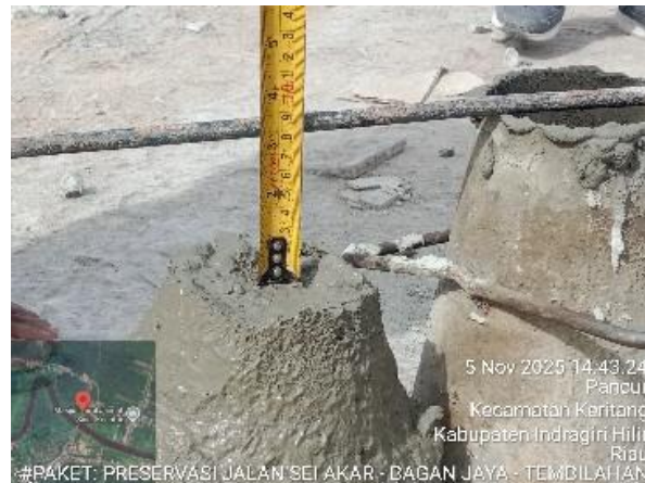
Gambar 3. 79 Pengukuran slump loneng
