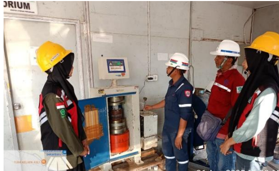
Gambar 3. 63 Uji kuat tekan beton Sumber: “Dokumentasi lapangan”
