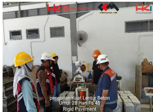
Gambar 3. 62 Uji kuat lentur beton Sumber: "Dokumentasi lapangan"
