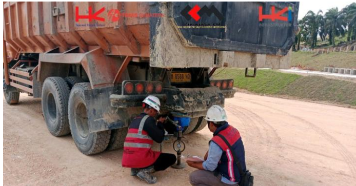
Gambar 3. 45 Pengujian proofrolling Sumber: "Dokumentasi PT Ciriayasa Cipta Mandiri"
