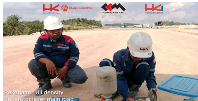
Gambar 3. 37 Pengujian density Sumber: "Dokumentasi PT Ciriajasa Cipta Mandiri"
