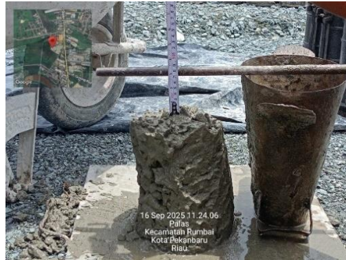
Gambar 3. 58 Uji Slump Sumber: “Dokumentasi lapangan”
