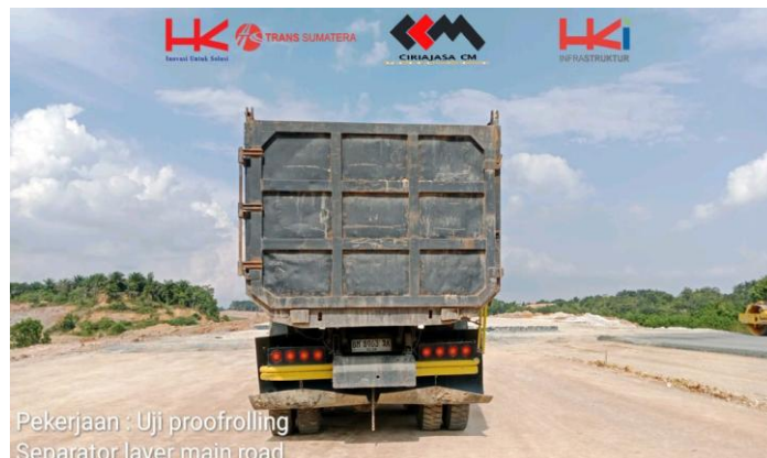
Gambar 3. 38 Pengujian proofrolling Sumber: "Dokumentasi PT Ciriajasa Cipta Mandiri"
