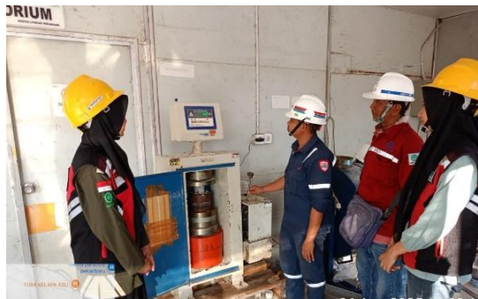
Gambar 3. 59 Pengujian Kuat Tekan Beton Sumber: “Dokumentasi lapangan”
