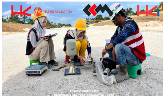
Gambar 3. 54 Tes Kepadatan Metode Sand Cone Sumber: "Dokumentasi lapangan"
