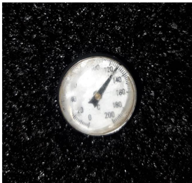
Gambar 4. 3 Pemeriksaan Suhu Pada Penghamparan AC-BC (Sumber Dokumentasi Lapangan 2025)
