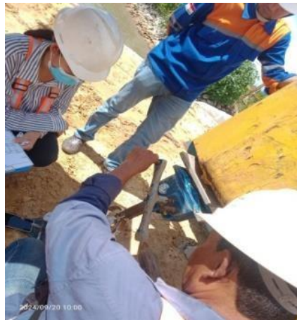
Gambar 3. 29 Pengujian Tes CBR
