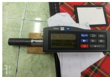
Gambar 3. 15 Proses Pengukuran Kekasaran Permukaan (Sumber : Dokumentasi Penelitian, 2026)
