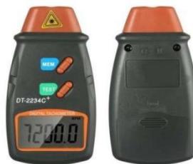
Gambar 3. 7 Tachometer (Sumber : Dokumentasi Penelitian, 2026)
