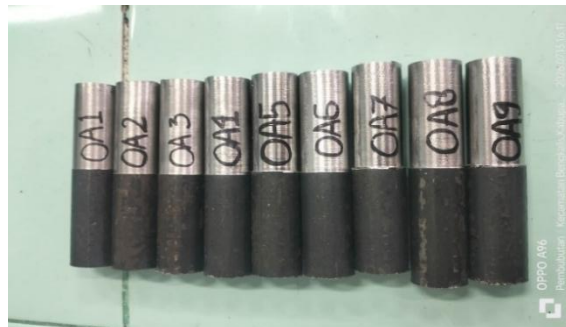
Gambar 4. 4 Hasil Permukaan Benda Kerja Setelah Proses Pembubutan (Sumber : Dokumentasi Penelitian, 2026)
