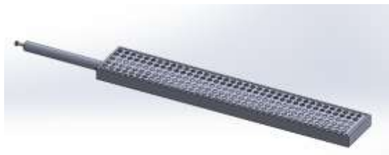
Gambar 2. 8 Burner Gas (Sumber :Dokumentasi penulis)
