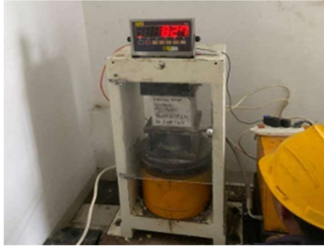
Gambar 3. 25 Uji Kuat Tekan Beton
