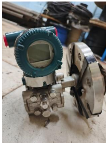
Gambar 3.1 Gauge Pressure Transmitter Sumber: (Dokumentasi, 2026)
