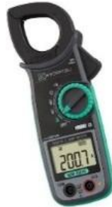
Gambar 2. 21 Tang ampere (Clamp Meter) Sumber : (Dokumentasi)
