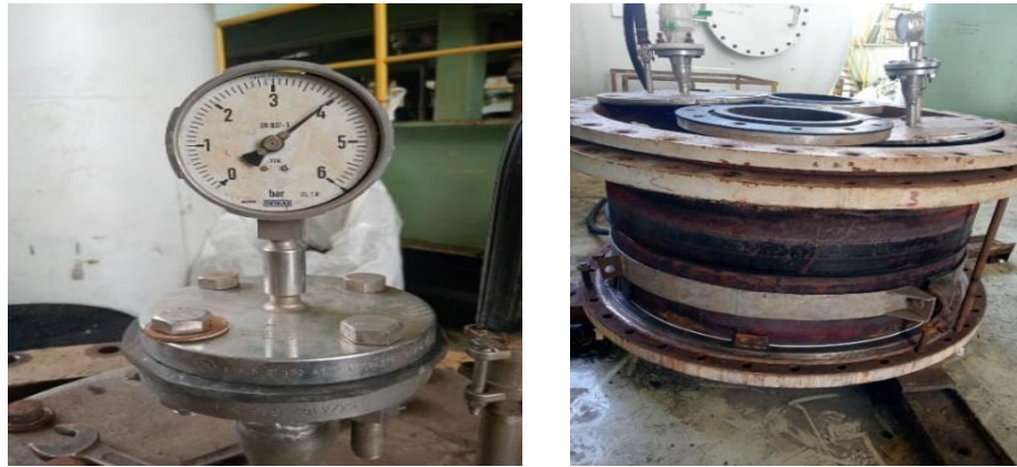
Gambar 2.9 Hydrotest Karbon Blok Menggunakan pressure gauge (manometer)
